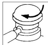
Drehen Sie den oben auf dem Dosenkörper befindlichen Pumpkopf, bis die darunter liegende halbkreisförmige Einkerbung in Richtung der Düse weist. Die Sprühdose ist nun gebrauchsfertig.
