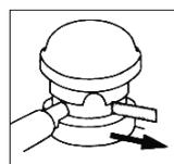
Entfernen Sie vor dem ersten Gebrauch die unter dem Pumpkopf befindliche Sicherheitssperre (Plastiklasche).
